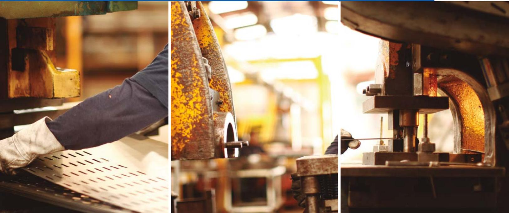
**Prensa:** Esta línea de máquinas procesa aceros al carbono en negro, galvanizados e inoxidables, de espesores hasta 3mm., considerando la matricería desarrollada.
