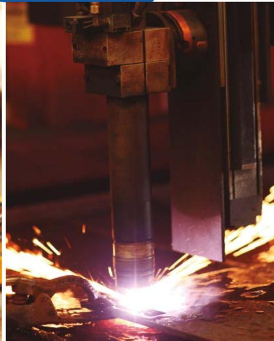
**Corte plasma CNC de Alta Definición:** Dimensionamiento y cortes de partes y piezas o geometrías complejas, realizadas mediante control computarizado con gran precisión y total compatibilidad con archivos CAD en extensión (.dwg) (.dxf).
