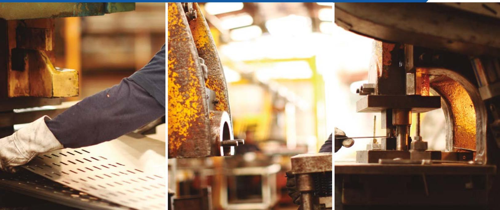
**Prensa:** Esta línea de máquinas procesa aceros al carbono en negro, galvanizados e inoxidable, de espesores hasta 3mm., considerando la matricería desarrollada.
